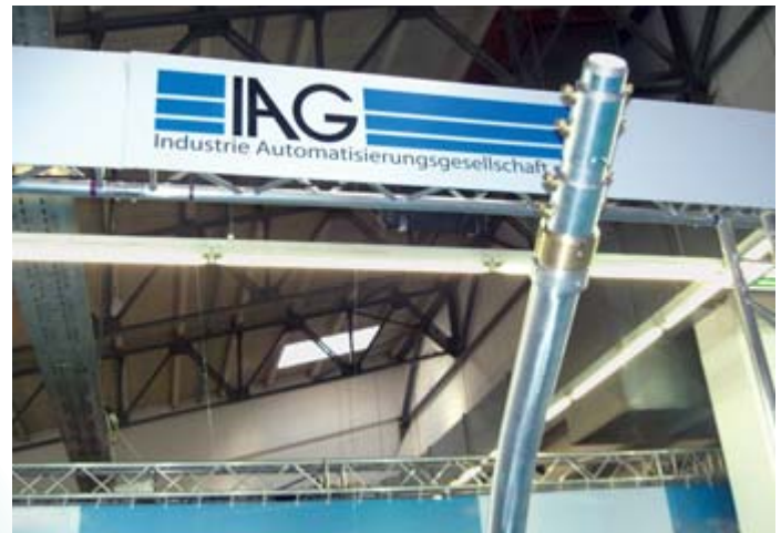
Die neue IAG-Lanze BL33 mit einem speziellen Innenmischsystem senkt den Druckluftverbrauch.
